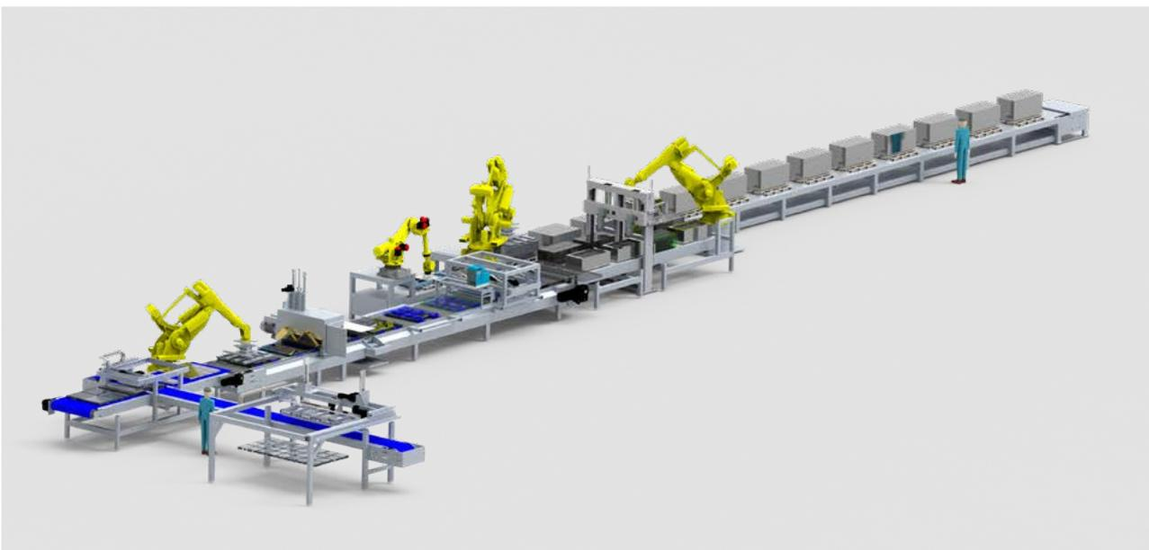
Optionen für die Produktbehandlung nach dem Aushärten: Kugelstrahlen, Bürsten, Imprägnieren, Bedrucken. Automatisches vertikales oder horizontales Verpacken auf Verkaufspaletten.
