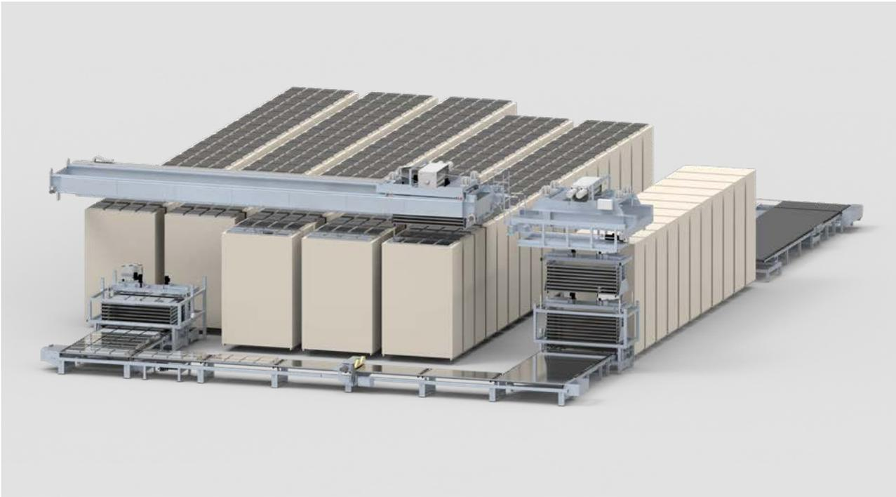
Die frischen Platten befinden sich auf konstruierten Stahlpaletten mit Füßen. Für den Paletten Transport im und aus dem Aushärtungsbereich gibt es verschiedene kundenbezogene Systeme. Dargestellt ist ein System mit Kränen. Ein Paletten Puffersystem ist optional.
