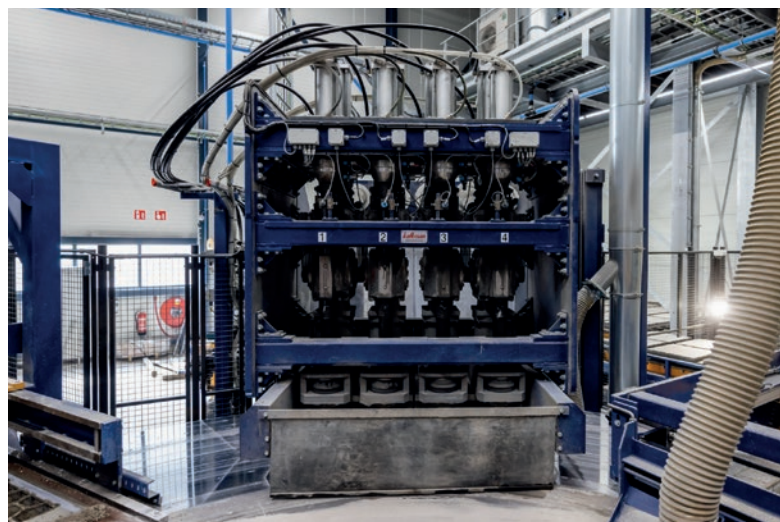
Zagęszczanie poprzez ubijanie.
