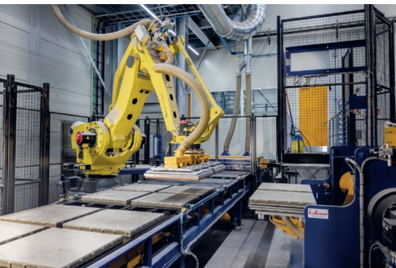
Odbiór świeżo wyprodukowanych płyt betonowych.
