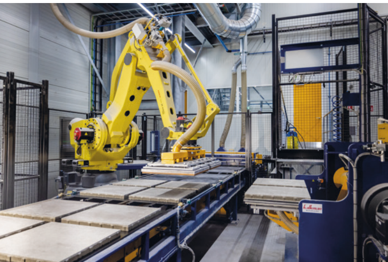
Réception d'une dalle de béton fraîche
