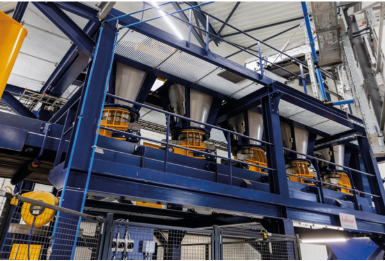
Farbmischsystem mit Silos für fünf verschiedene Farben
