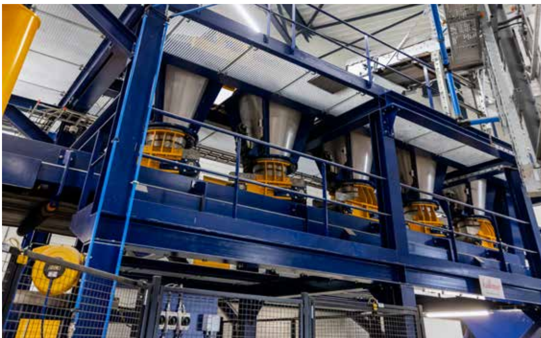
Color mixing system with silos for five different colors. Mixing ratio freely adjustable Farbmischsystem mit Silos für fünf verschiedene Farben. Das Mischverhältnis ist frei einstellbar
